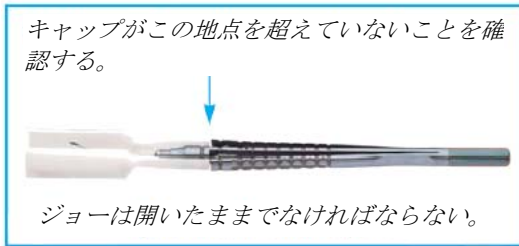
図 8：保護キャップを超小型器具に装着する。
