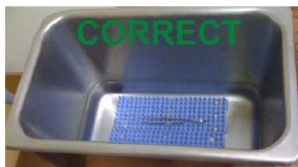
図 5：超音波洗浄には常にシリコンマットを使用すること。
